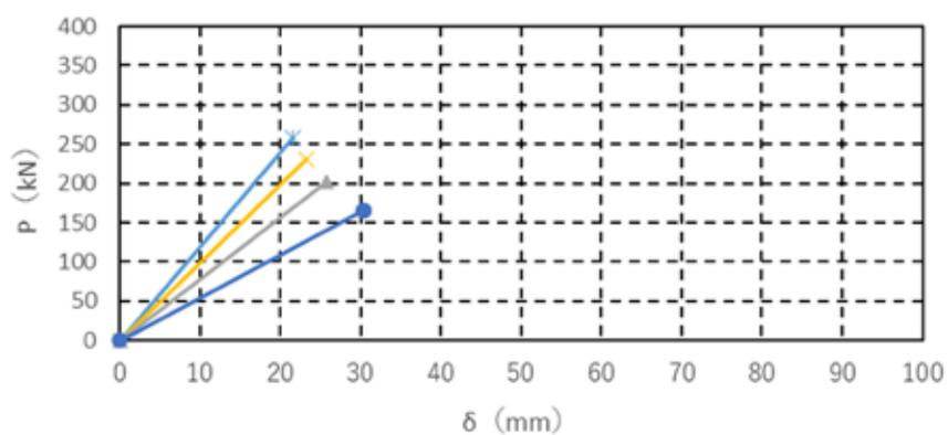
構面高さ 4.0m の荷重変形関係の計算値
