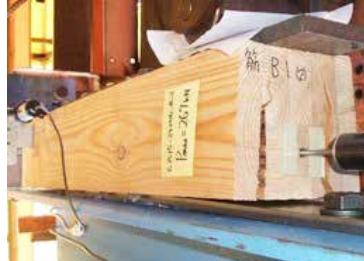
木材の割裂破壊
