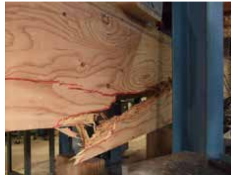
ウェブの曲げ破壊 (試験体 1)
