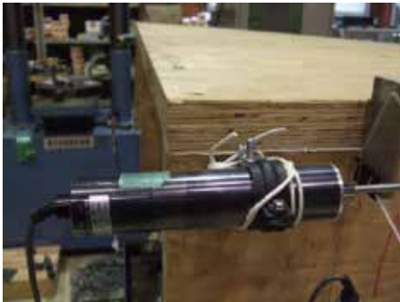
部材間ずれの発生なし (試験体 1)
