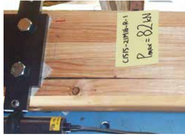
木材の割裂破壊
