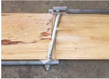
ボルトの曲げ降伏
