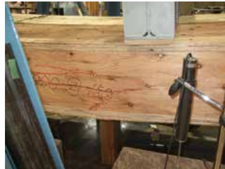
ウェブの曲げ破壊 (試験体 2)
