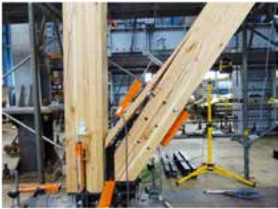
1/50rad ドリフトピンの破断
