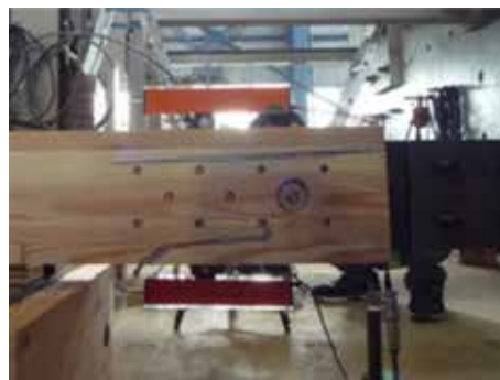
縁寄りのドリフトピン近傍の割裂破壊
