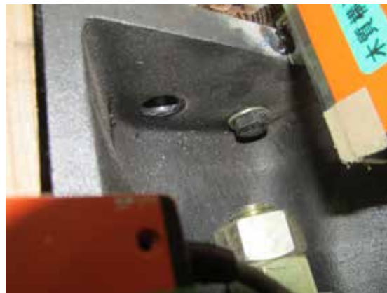
ハイテンションボルトの破断
