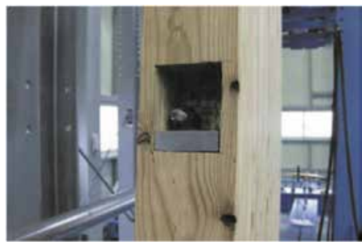
引張側ボルトの伸び・破断
