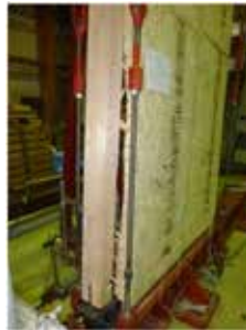
最終的に割裂破壊した集成柱（同）
