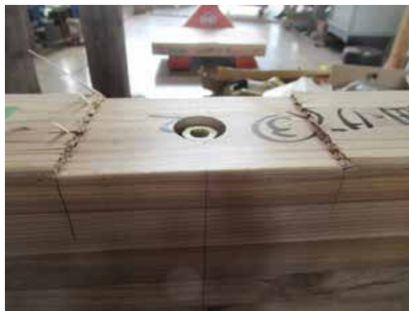
写真 1 LSB の押し込みと木材めり込み破壊
