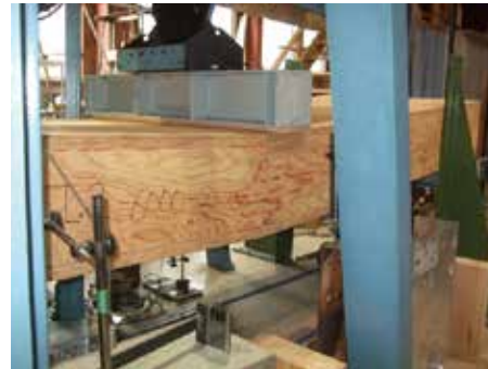
ウェブの曲げ破壊 (試験体 2)
