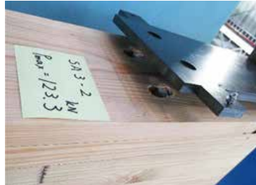
ボルトの破断
