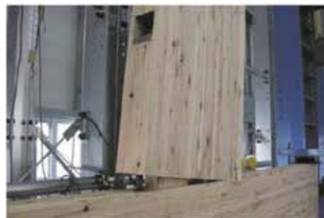
梁木口の柱側面へのめり込み
