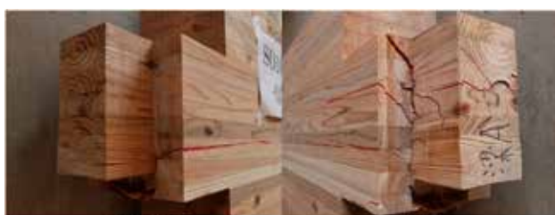
試験終了後の梁端部 No.3
