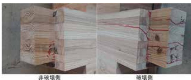
試験終了後の梁端部 No.1
