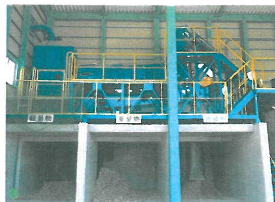
■ 風力分別処理装置 (デ・ストーナ) 振動・風力・エアナイフを併用し、重量物と 軽量物に分別、同時に残りの残査も排出します。
