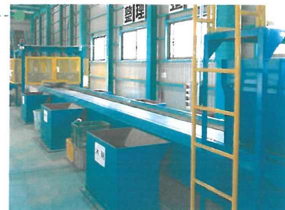
■ 手選別エリア 土、砂を取り除いたゴミを木屑、廃プラスチック、 紙屑に手作業により分別します。
