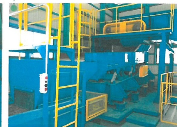
■ 低騒音篩分機 (フィンガースクリーン) 強力な振動でふるいにかける 20 アンダー以下のもの (残査) を排出します。
