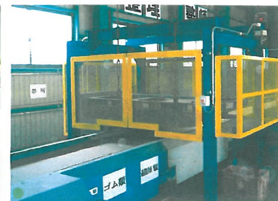
■ ロータリー式磁選機 協力的な磁力により、鉄屑のみを選別します。
